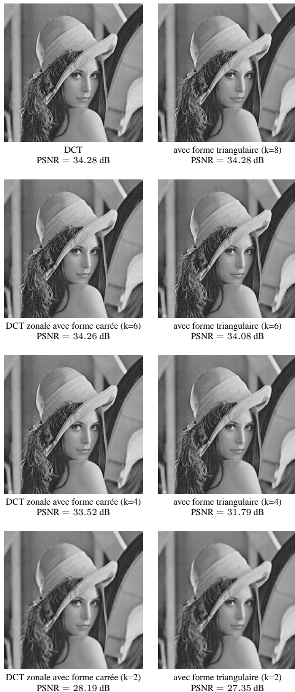
Figure 4 – image Lena codée à 0.5 bpp, pour les deux formes zonales et différentes valeurs de k .
