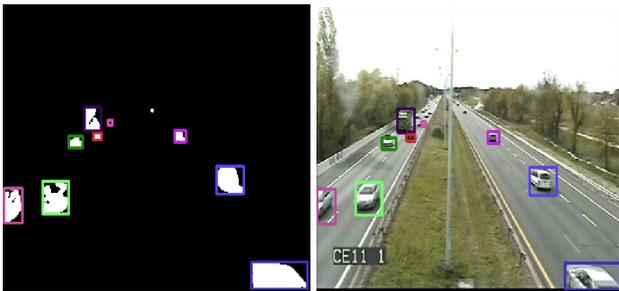
Figure 6 – Exemple d'extraction d'objets sur l'image d'avant-plan.
